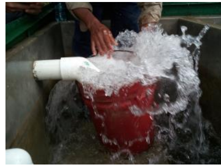
Fotografía 2: Aforo en Filtro lento, en sistema de agua potable rehabilitado en San Marcos La Laguna, Sololá.
